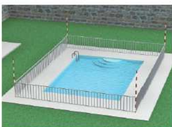
Piscine privative équipée d'une barrière de sécurité La barrière de sécurité reste visible tant que le niveau d'eau est inférieur à sa hauteur Les piquets délimitent l'emprise au sol de la piscine lorsque le niveau de l'eau dépasse la barrière
