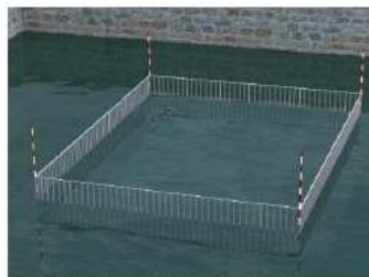
Piscine privative équipée d'une barrière de sécurité La barrière de sécurité reste visible tant que le niveau d'eau est inférieur à sa hauteur Les piquets délimitent l'emprise au sol de la piscine lorsque le niveau de l'eau dépasse la barrière
